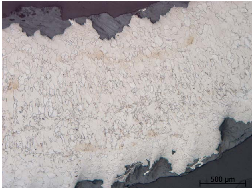
Figur 5. Hel lös ring. Etsat polerat prov. Efter etsning framträder ett mönster med ferritkorn. I denna del av ringen är de något långsträckta vinkelrätt mot ringens ytterkanter, framförallt i de centrala delarna.
