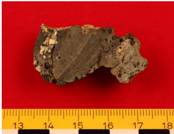
Figur 2. Den delade slaggens (F464) snittyta visar ännu tydligare kontakten mellan en glasig, dvs. smält lerig komponent (här till vänster) och den egentliga slaggen. Denna är homogen i sammansättning men har ytterligare några enstaka insmälta partier av silikatiskt material i den högra delen.
