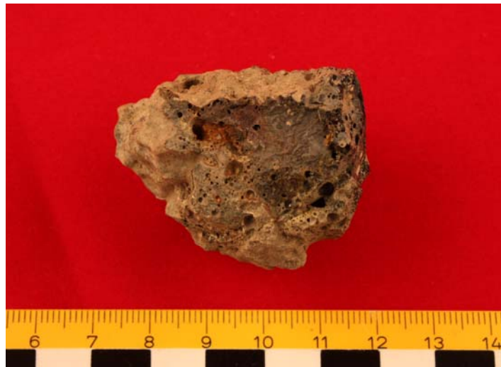
Figur 1. I de förska brottyorna av slaggen F464 framträder två olika drag. Det ena återfinns längs en plan brottyta som är glasigt svart (längst till höger) med enstaka osmälta kvartskorn. Det andra, som dominerar, är mattare till metalliskt i glansen och är en grå tämligen homogen slagg med enstaka hålrum.
