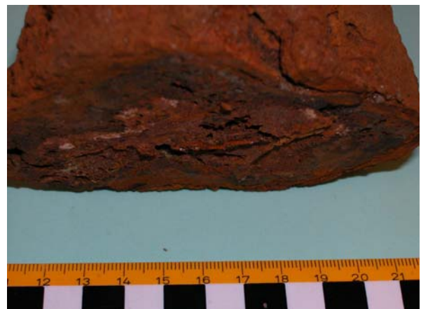
Figur 5. Den större järnbiten, ID200569 (F386). Tvärsnittet innehåller ett större stycke metalliskt järn som är svart att se på bilden, järnet har partvis fått en beläggning av rost.
